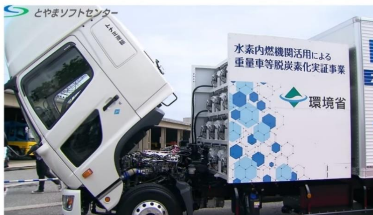
富山県のトナミ運輸で、実証実験に入る時にキャビンを上げて水素エンジンと水素ポンプを観ています。
